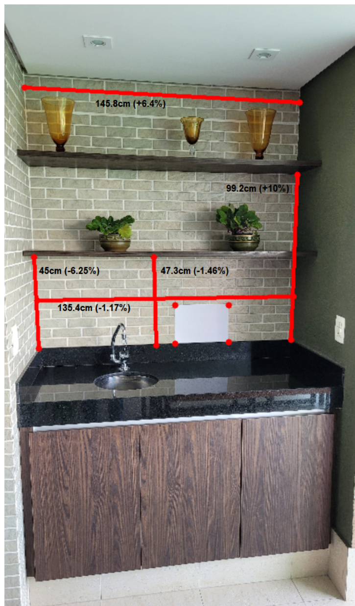
Figura 23 – Teste realizado na varanda, com as dimensões conhecidas de uma folha A4.
